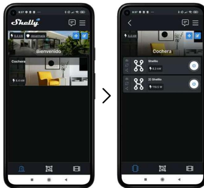
Este es el aspecto que debería tener la app cuando la instalación se ha completado. Podemos observar que, tanto el medidor del hogar ("Shello") como el solar ("2) Shello"), marcan un consumo positivo y razonable. Si vemos que las medidas son negativas o demasiado bajas, deberíamos revisar el sentido de las pinzas.
