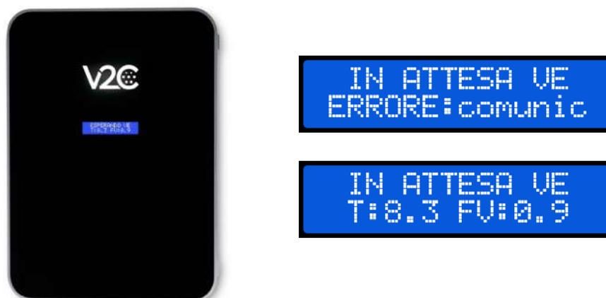
Trydan visualizzerà un messaggio di errore se non riesce a connettersi al Solax, controlla la tua connessione e assicurati che i due dispositivi siano collegati alla stessa rete. Se la connessione è corretta, visualizzerà le misure
