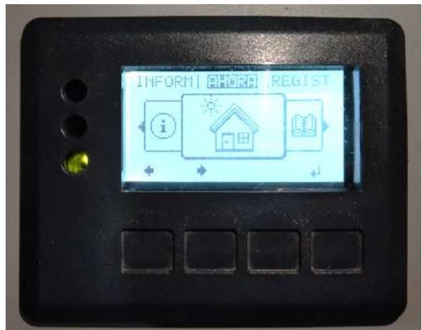
2.- Presionar sobre el segundo botón para desplazarnos hacia la derecha hasta llegar a la opción de configuración y presionar sobre la tecla 4 para aceptar.
