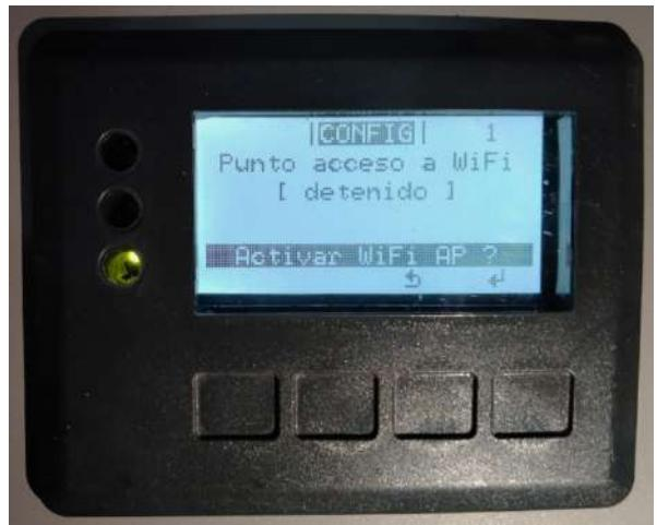
5.- Una vez activado, es importante anotar los datos suministrados, ya que el proceso continua en el ordenador para la conexión a la red WiFi inalámbrica que emite el inversor Fronius.
