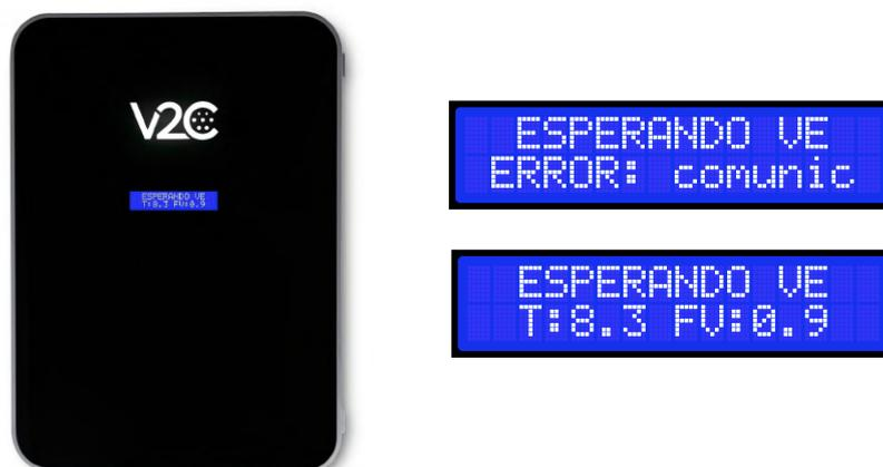
Trydan mostrará un mensaje de error si no consigue conectar con Huawei, revise su conexión y asegúrese de que los dos dispositivos están conectados a la misma red. Si la conexión es correcta mostrará las mediciones.
