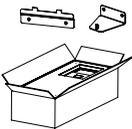
1. Retirer les ancrages pour la fixation au mur de l'emballage.
